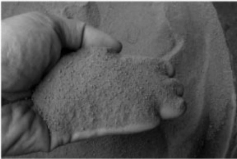
ภาพที่ ๓ กรองเอาเศษดินเศษทรายที่ไม่ต้องการออก
