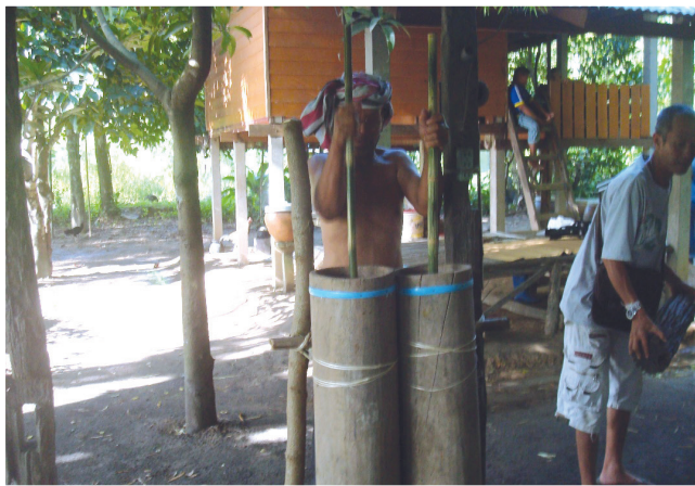
ภาพที่ ๒ ท่อไม้ไผ่สำหรับเป่าลมอัดเข้าเตาเผาเหล็กเพื่อเพิ่มความร้อนเข้าเตา
