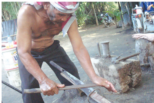
ภาพที่ ๓ การขัดแต่งมีดด้วยตะไบ
