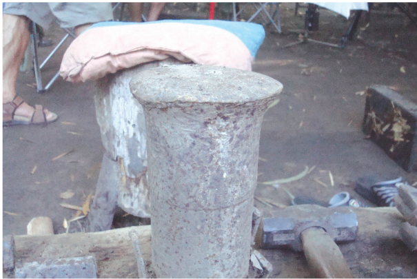
ภาพที่ ๕ ทั่งตีเหล็กแบบดั้งเดิมสำหรับใช้รองรับการตีเหล็ก
