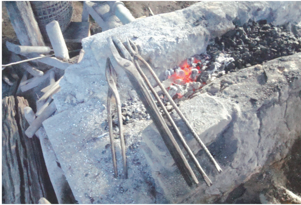
ภาพที่ ๔ เตาเผาเหล็กมีดพริ้วแบบโบราณทำจากดินเหนียว
