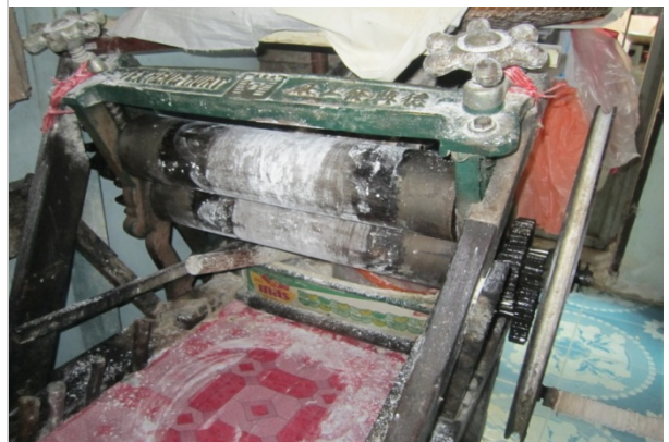
เครื่องจักรรีดยางที่นำมาประยุกต์ใช้เป็นเครื่องจักรรีดแป้งให้เป็นแผ่นบางและแน่น
